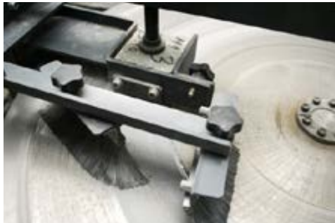
DLAŽBA PŘI ZKOUŠCE OBRUSNOST POVRCHU
