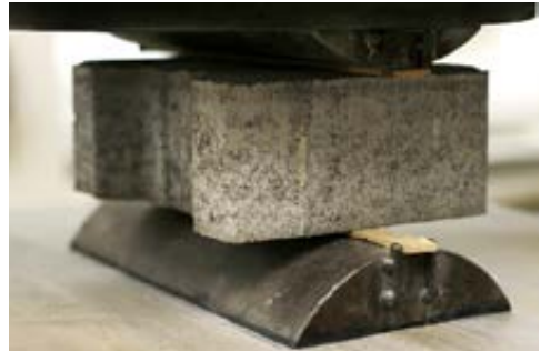
DLAŽBA PŘI ZKOUŠCE PEVNOST V PŘÍČNÉM TAHU
