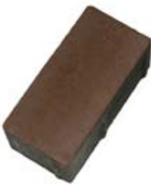
Povrch dlažby bez vápenného výkvětu
