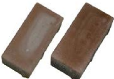
Povrch dlažby s vápenným výkvětem před čištěním a po vyčištění Rebanitem S
